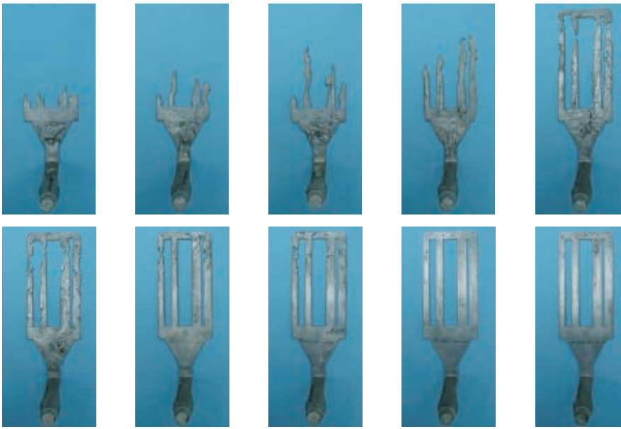
Bild 2. Das Erstarrenverhalten und die Trägheitskräfte beeinflussen deutlich das Formfüllverhalten
