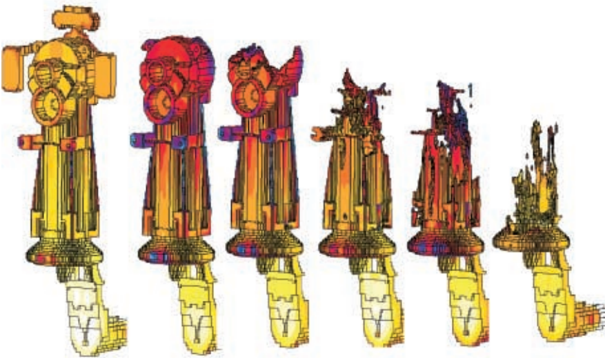
Bild 4. Gießversuch und Füllstudien des Bohrhammergehäuses nach gießtechnischer Verbesserung des Anschnitts
