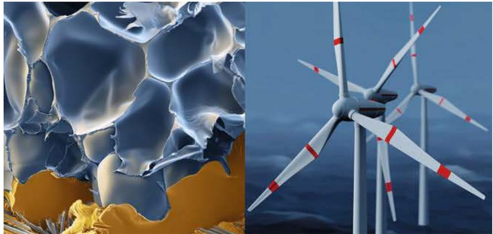
**Bild 1.** Der neue PET-Schaumstoff zur Herstellung von Windrotorblättern (rechts) wird im Kern des Flügels mit Glasfasern (links grau) verstärkt, dann mit Epoxidharz (links gelb) umgossen und abschließend mit wetterfesten Beschichtungen ausgerüstet
