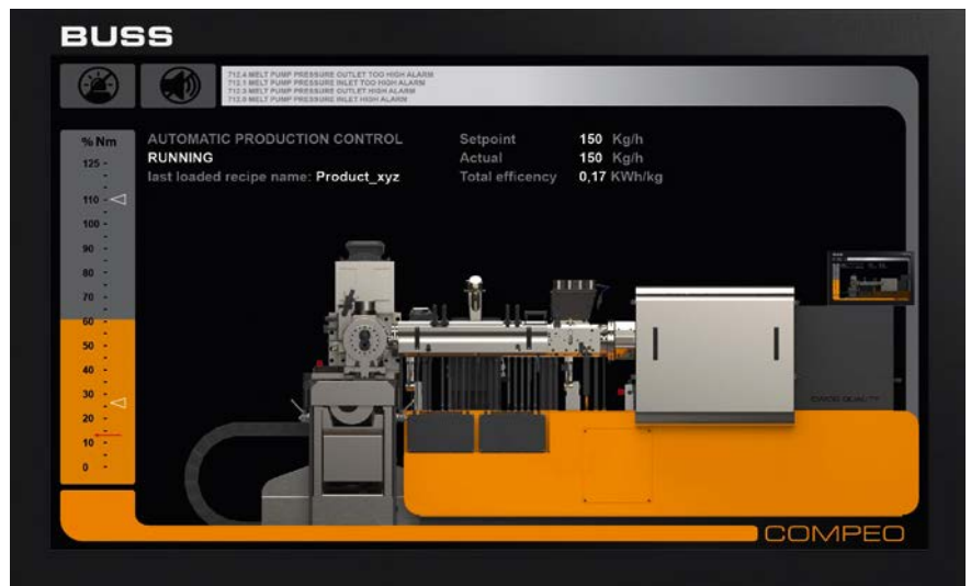
Bild 8. Startbildschirm: Die Steuerung zeigt auch im Ruhezustand die wichtigsten Prozessparameter an (© Buss)
