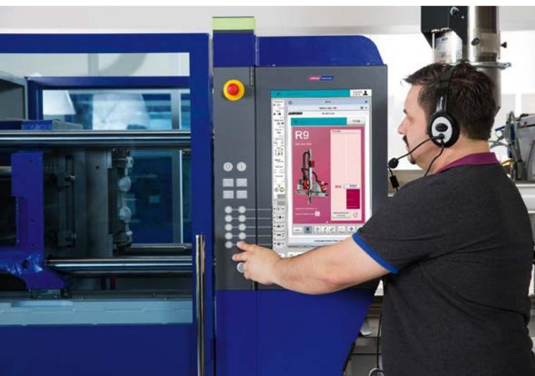
Ein Bediener nimmt Roboter-Einstellungen über die Unilog-B8-Steuerung der Spritzgießmaschine vor (© Wittmann)
