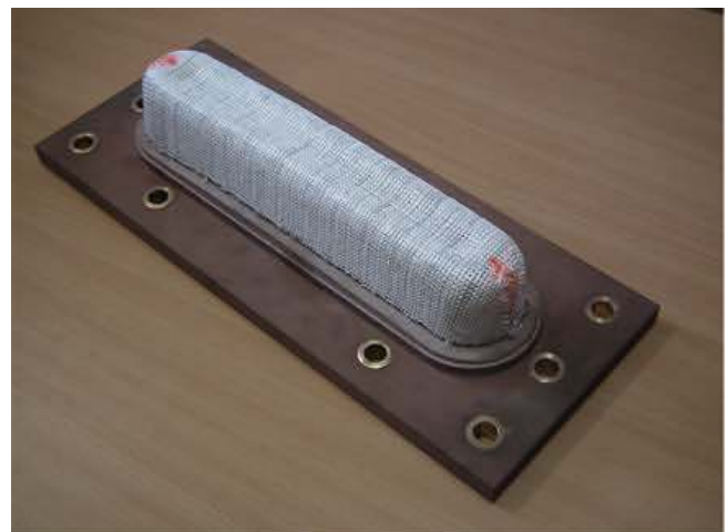
Bild 4. Umgeformte textile Verstärkungsstrukturen a) Zuschnitt 1 (vier Entlastungsschnitte); b) Zuschnitt 2 (zwei Entlastungsschnitte)
