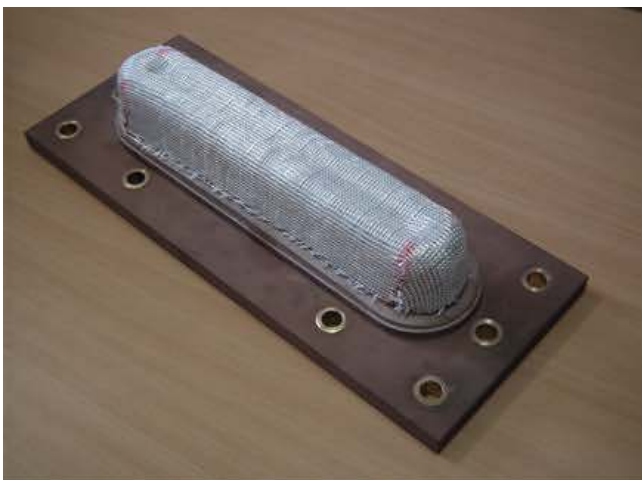
Bild 4. Umgeformte textile Verstärkungsstrukturen a) Zuschnitt 1 (vier Entlastungsschnitte); b) Zuschnitt 2 (zwei Entlastungsschnitte)
