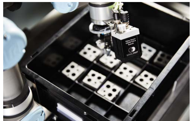
Bild 1. Ein kamerageführter Roboter kann auch solche Teile greifen, die nicht exakt positioniert sind. Hier weist ihm ein Vision-Sensor der Visor-Reihe den Weg © SensoPart Industriesensorik
