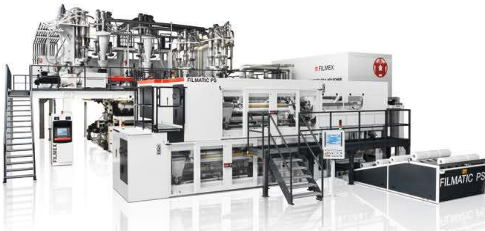
Bild 6. Die Filmex-Gießfolienanlage liefert mit dem neuen Wickler Filmatic-PS-Stretchfolien höchster Qualität
