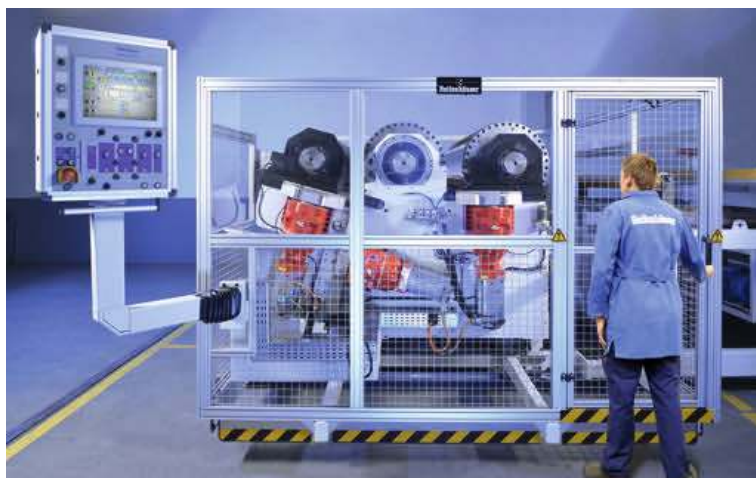
Bild 8. Das Glättwerk Mirex MT stellt den Glättspalt in der laufenden Produktion per Knopfdruck ein. Die Spaltgenauigkeit ist um Faktor 10 besser als bei bisherigen Glättwerken (Bild: Reifenhäuser)
