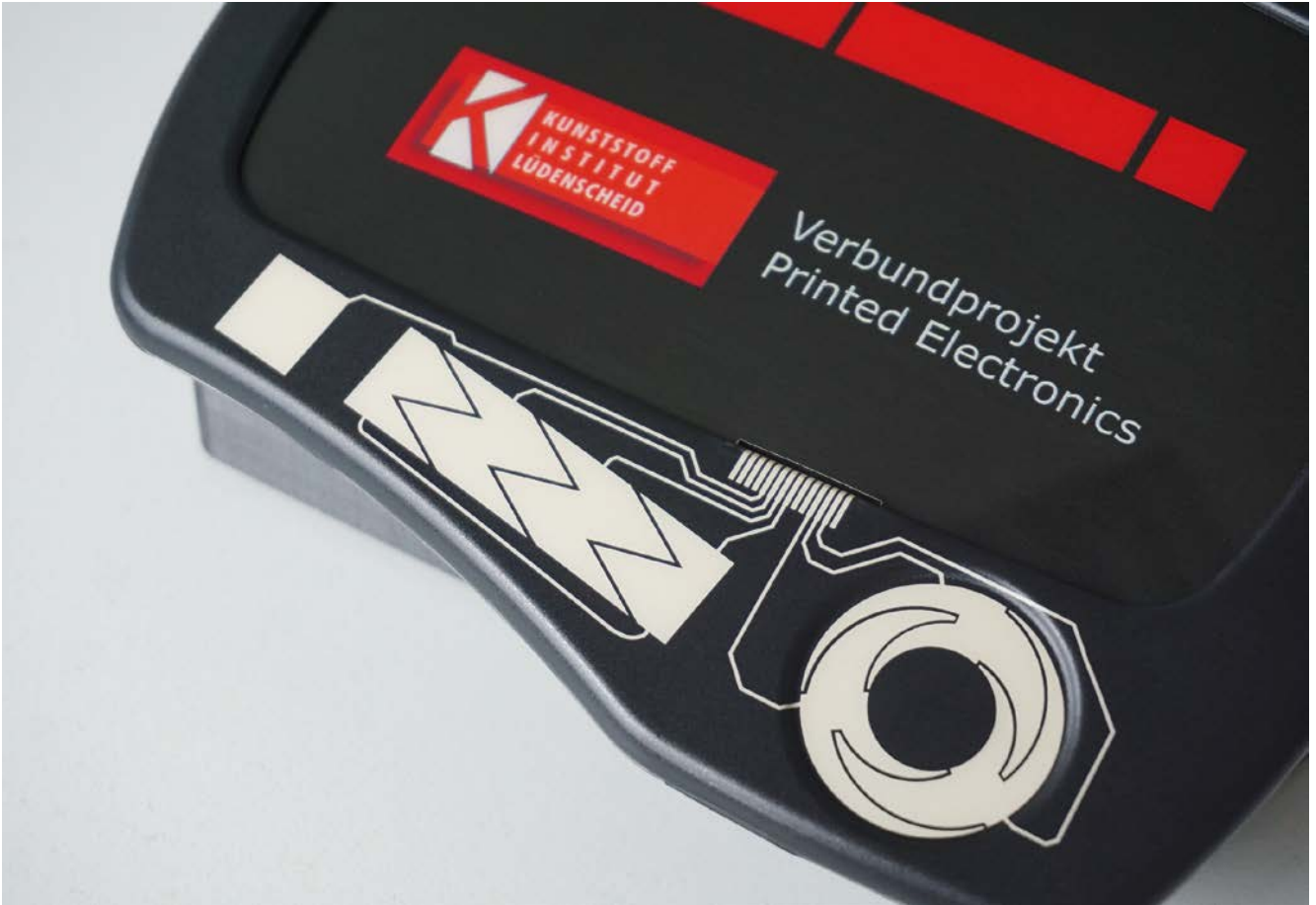
Der Demonstrator „Naviblende-Touch“ wurde im Verbundprojekt „Printed Electronics“ entwickelt. Aufgrund des starken Interesses an zu neuen Bedienkonzepten wird das Projekt in einer zweiten Runde fortgesetzt (© KI Lüdenschied)
