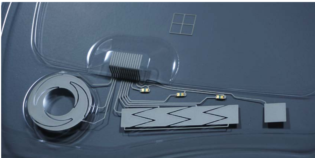
Bild 1. Bisher werden Folien mit aufgedruckter Elektronik verformt und hinterspritzt. Die dabei verwendeten Anschlussfähnchen sind aber mechanisch nicht besonders belastbar
