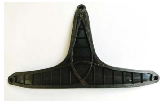
Bild 7. Lastpfadoptimiertes Demonstratorbauteil mit Kraffteinleitungselementen und Rippenstruktur (© IKT)
