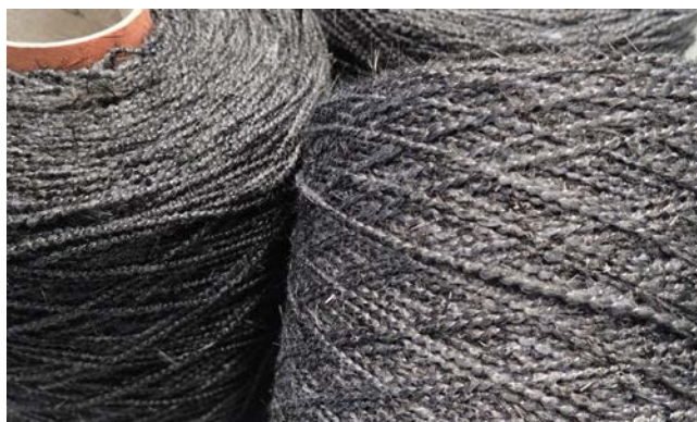
Bild 4. Spulen des fertigen Stapelfaser-Hybridgarns aus recycelten C- und PA-Fasern (© DITF)
