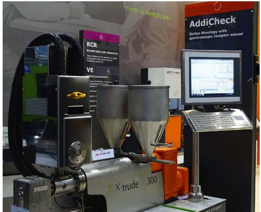
**Bild 4.** AddiCheck-Messsystem für Extrusionsanwendungen (© Göttfert Werkstoff-Prüfmaschinen)
