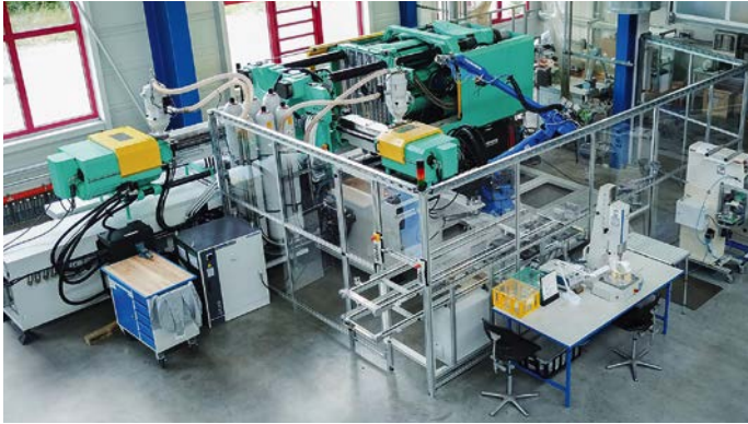
Bild 7. In der Fertigungszelle werden acht einzelne Prozesse mit kollaborativen Robotern verknüpft © Varioplast
