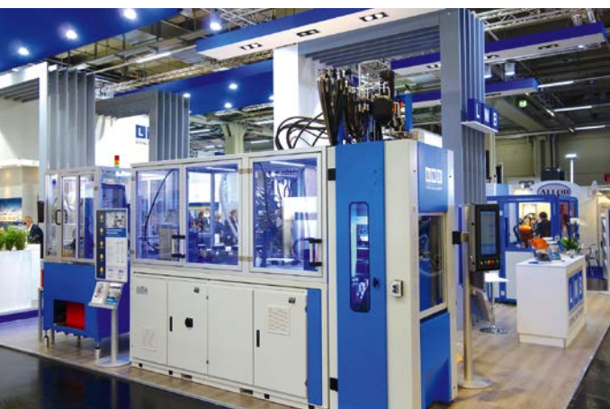
Bild 6. Zwei Vertikalmaschinen sind durch eine angepasste Handling- und Bearbeitungsperipherie zu einer vollautomatischen Produktionszelle kombiniert © LWB Steinl
