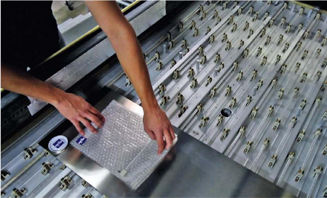
Das Heizsystem Time Shifted Heat Control besteht aus Halogen-Infrarotstrahlern, die durch einen individualisierten Berechnungsalgorithmus effizient arbeiten. Die einzelnen Strahler können schnell und ohne Elektriker gewechselt werden
