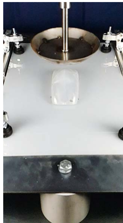
Bild 8. Aufbau eines Falltests zur Ermittlung der mechanischen Stabilität beim Einsatz von 1% Iridin 6163 Way bzw 1% Aluminiumpigment in PP (© Arbeitskreis für Werkstoffprüfung, Hochschule Darmstadt)
