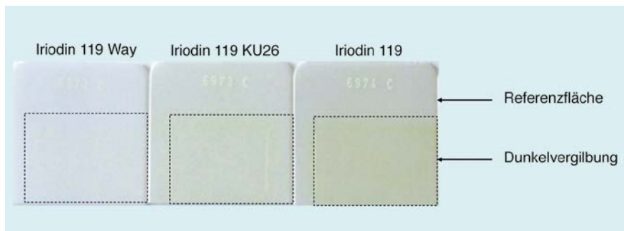
Bild 2. Vergleichstests zur Dunkelvergilbung mit unterschiedlichen Verkapselungsarten. Iriodin 119 Way zeigt nach 284 h Exposition mit UV-Strahlung im Gegensatz zu dem Standard-Pigment rechts keine Vergilbung (© Merck)
