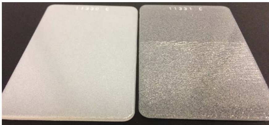
Bild 7. Mikrorisse nach 400 h im Sun-Tester gemäß DIN EN ISO 11341 von Iridin 6163 Way (links) und Aluminium-Flake-Pigment mit 1% in PP (rechts) (© Merck)
