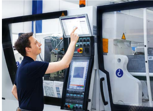
Bild 3. Die Überwachung des Werkzeuginnendrucks erleichtert die Prozessüberwachung und Qualitätssicherung beim Spritzgießen: Christoph Merhold, Ingenieur und bei Riegler Key Account Manager für medizintechnische Produkte
