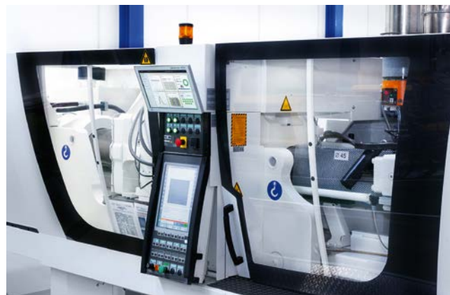
Bild 2. Das Prozessüberwachungssystem ComoNeo (mittig) verbessert die Spritzgießfertigung nachhaltig und vereinfacht die Übertragung eingefahrener Prozesse auf andere Maschinen (© Kistler Gruppe)
