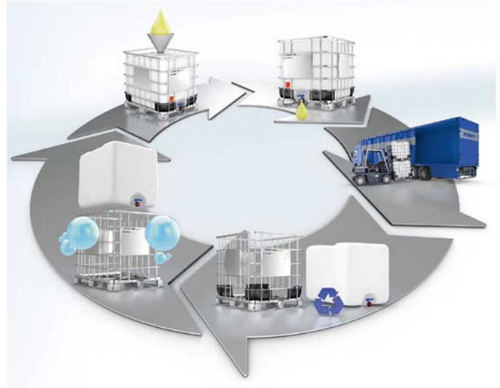
Bild 6. Container-Kreislaufsystem: Durch den Austausch der IBC-Kunststoffhülle, die zu Paletten recycelt wird, erfüllen rekonditionierte und neue IBC dieselben Sicherheitsanforderungen (© Schütz)
