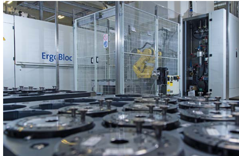
Bild 4. Höhere Automatisierung: Ein Roboter kann sich optional um den Formenwechsel an der Contiform-Streckblasanlage kümmern (© Krones)
