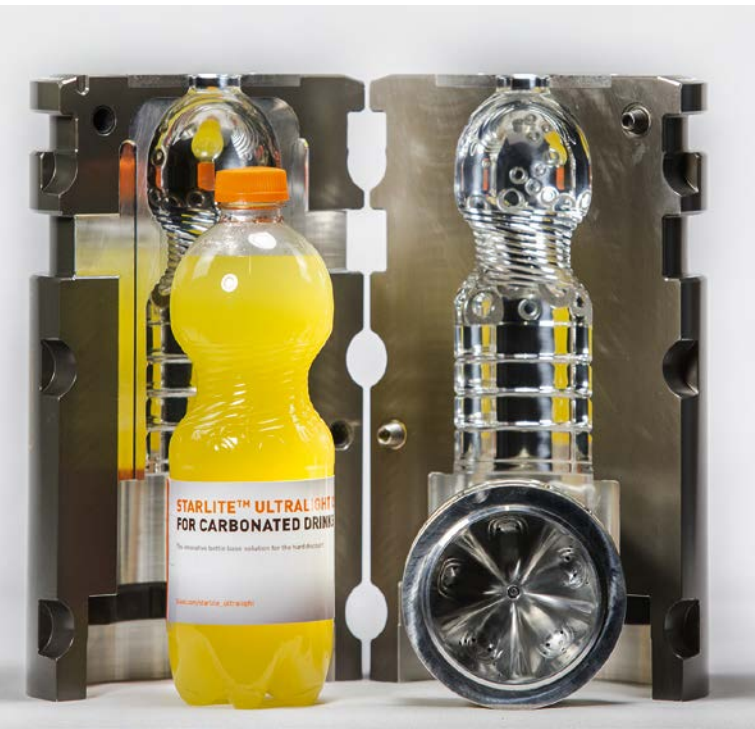
Bild 3. Leichtgewicht: Das Flaschendesign „StarLite UltraLight“ spart fast ein Viertel des üblicherweise verwendeten Materials ein, ohne Griffestigkeit oder Barrierewirkung einzubüßen (© Sidel)
