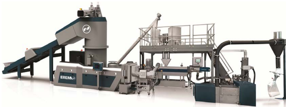
Bild 3. Durch die Inline-Compoundierung der Rezyklate werden die Materialeigenschaften gezielt eingestellt
