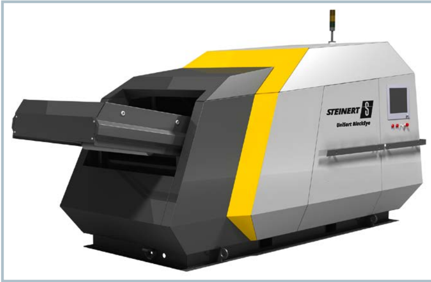
Bild 1. Der UniSort BlackEye ermöglicht die Sortierung von schwarz eingefärbten Kunststoffen
