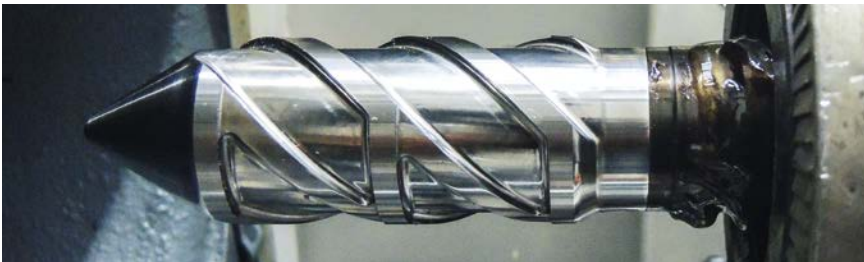
Bild 9. Schneckenspitze mit Staufunktion: Die veränderte Geometrie und fortlaufende Rotation verhindern einen Schmelzerückfluss in der Einspritz- und Nachdruckphase (© KraussMaffei)
