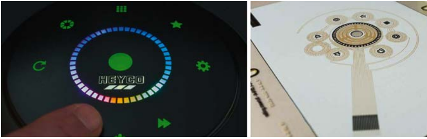
Bild 8. Folienhinterspritzte Blende mit Dekor und aufgedruckten kapazitiven Tasten. Die Funktionssymbole sind lasurschwarz hinterlegt, sodass die Tasten nur bei entsprechender Hinterleuchtung sichtbar sind. Das Drucklayout beinhaltet ein Rad, mehrere Tasten und einen seitlich herausgeführten Flextail (© Heyco)
