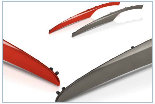
Bild 6. Alle vier Teile der A-Säulenverkleidungen werden in diesem Wendeplattenwerkzeug gespritzt und nach dem Wenden des Werkzeugs in der Lackkavität überflutet – in einem einstufigen sowie löse- und trennmittelfreien Prozess (© Panadur, KraussMaffei)
