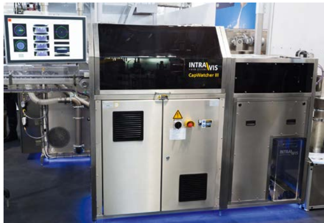
Bild 11. Anlage für die optische Überwachung von Verschlusskappen: Die tatsächlich gemessenen Qualitätsmerkmale fließen in die Prozessregelung (© Intravis)
