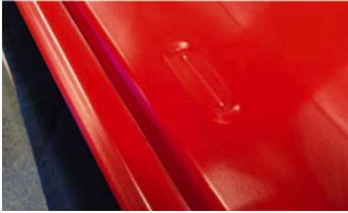
Bild 15. Die Breitschlitz-Heißkanaldüse FDU erlaubt größere Durchsatzmengen pro Zeiteinheit und damit kürzere Einspritzzeiten, ohne wesentliche Abstriche bei der Anschnittqualität (siehe die Abrisslinie an einer Fleischkiste links) akzeptieren zu müssen © Hanser/C. Doriat, Haidlmaier
