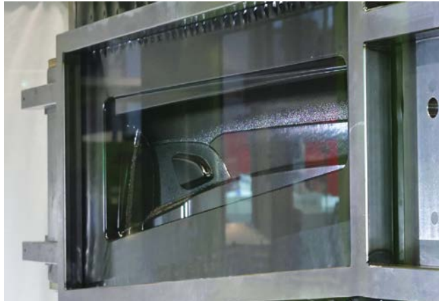
Bild 7. Werkzeughälfte für das Tiefziehen und Strukturieren von TPO-Folien. Der Prägeprozess beginnt während des Aufheizens, indem die Folie (hier schwarz) durch Vakuum in die IMG-Form gezogen wird (© Engel)
