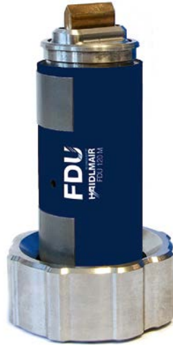
Bild 15. Die Breitschlitz-Heißkanaldüse FDU erlaubt größere Durchsatzmengen pro Zeiteinheit und damit kürzere Einspritzzeiten, ohne wesentliche Abstriche bei der Anschnittqualität (siehe die Abrisslinie an einer Fleischkiste links) akzeptieren zu müssen © Hanser/C. Doriat, Haidlmaier
