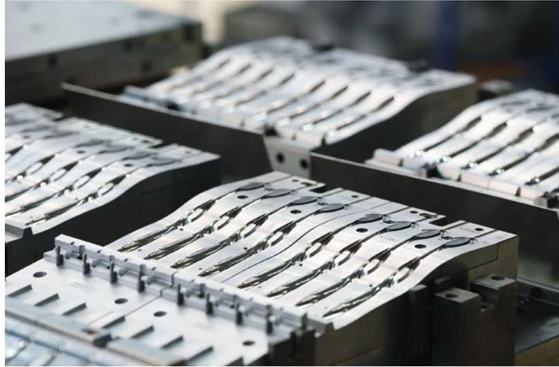
Das Zahnbürsten-Werkzeug „Z.Platform line“ besteht aus einer Stammform und separaten Formeinsätzen. Für ein neues Modell müssen nur neue Kavitäten für den Zahnbürstengriff- und -kopf hergestellt werden
