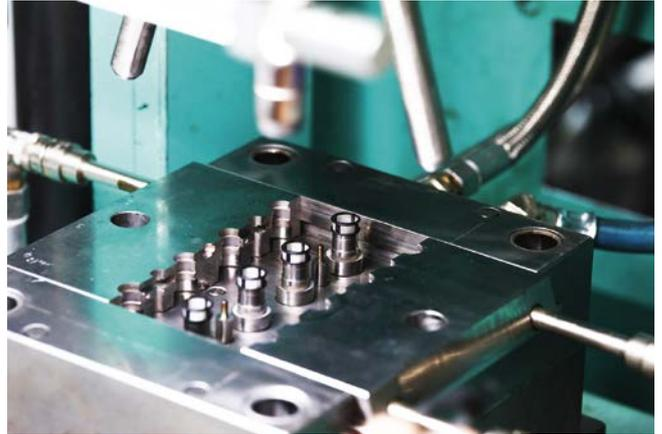
Zu den Kompetenzen von Stolz & Seng gehört die Herstellung von Mikroteilen ab 2 mg bzw. ab einer Wanddicke von 0,3 mm ebenso wie Bauteile aus hochtechnischen Kunststoffen, das Umspritzen von Metallgewebe und die Herstellung von Filtern und Sieben (© wortundform)
