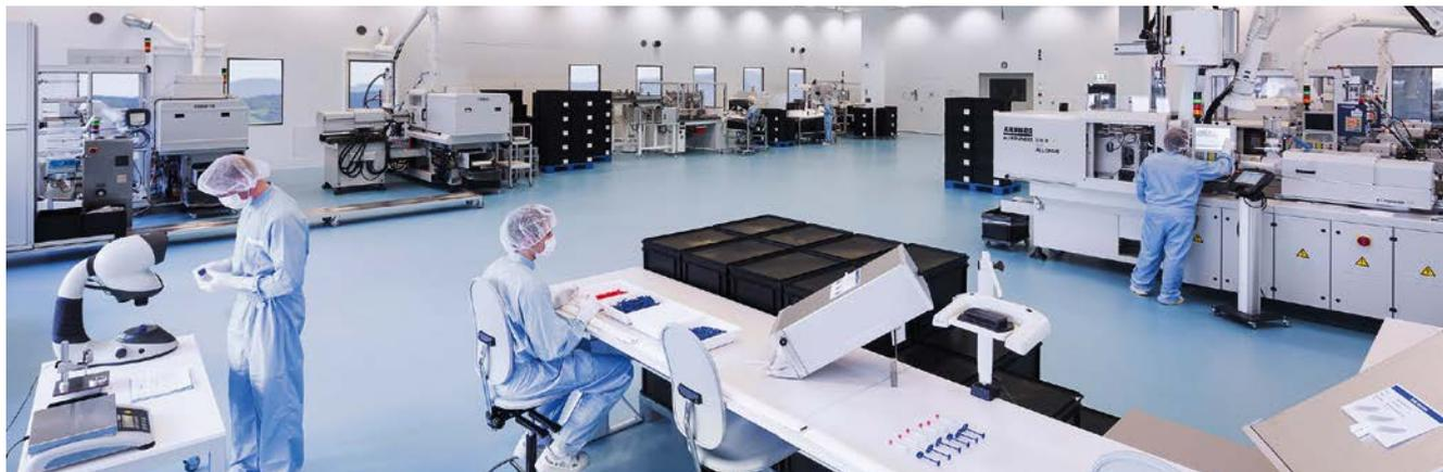
Spritzgießen und Bauteilmontage im Reinraum der Klasse ISO 7: Auf einer Fläche von 650 m<sup>2</sup> produziert Wild & Küpfer 1K- und 2K-Teile für die Medizinbranche, die mit voll automatisierten Montage- und Verpackungsrobotern zu hochspezialisierten Systemlösungen zusammengefügt werden (© Wild & Küpfer)
