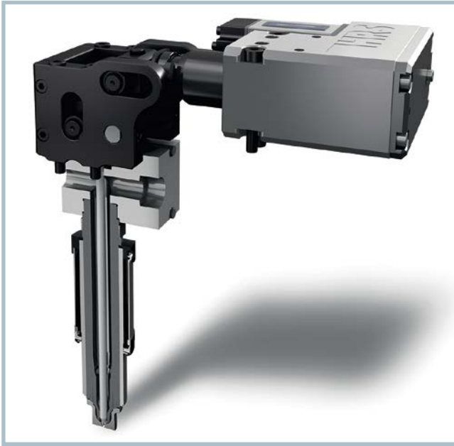
Bild 3. Flexflow erlaubt Spritzgießern, mit einem größeren Prozessfenster zu arbeiten. Per Servo-Antrieb können Drücke und Fließraten während des gesamten Spritzgießprozesses einfach, exakt und flexibel über die Nadelverschlüsse gesteuert werden (© HRSflow)
