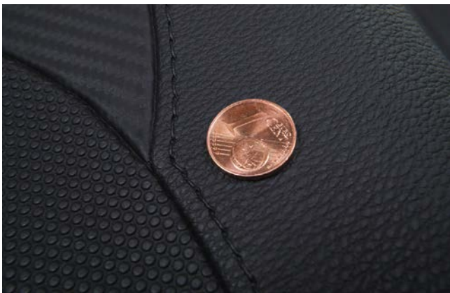
Bild 2. Sogar den Twist im Garn kann man abbilden: Detailaufnahme der DecoJect-Türverkleidung (© wortundform)
