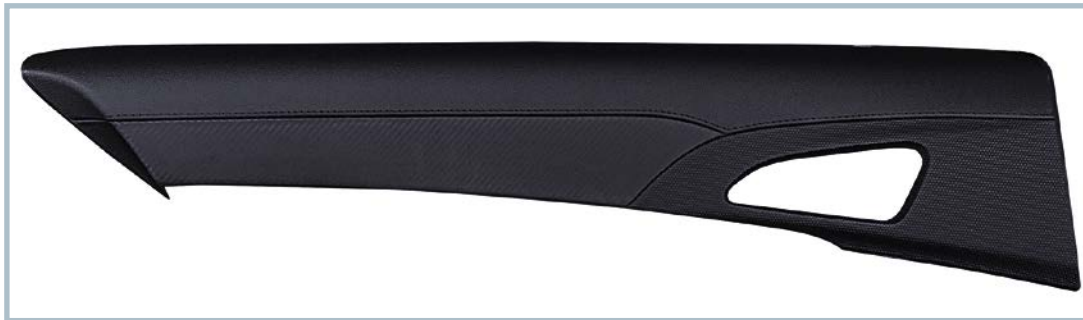
Bild 1. Der Herstellungsprozess umfasst das Strukturieren des Dekors im Werkzeug, das Hinterspritzen im MuCell-Verfahren und den Beschnitt zum fertigen Bauteil (© Engel)
