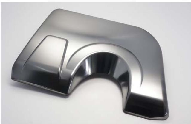
Bild 4. Der Claza-Demonstrator wurde von der Firma nolax für das gleichnamige Start-up entwickelt. Die Folie wird direkt mit PP bzw. rPP (recyceltem Polypropylen) hinterspritzt, das Bauteil kommt fertig verarbeitet aus dem Werkzeug (© nolax)
