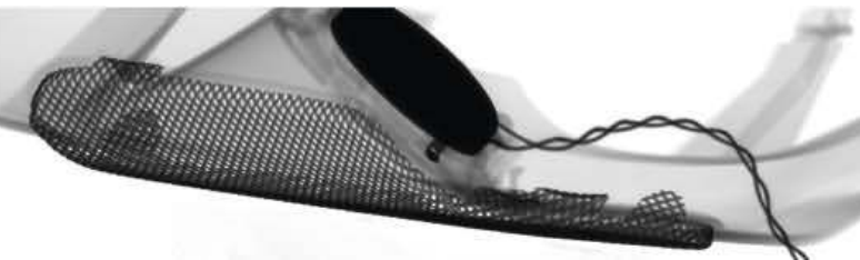
Bild 2. Röntgen-Durchstrahlungsaufnahme einer Lautsprecherbaugruppe, bestehend aus Kunststoffgehäuse (hellgrau), Schutzgitter (dunkelgrau) und Lautsprecher mit Kabel (schwarz)
