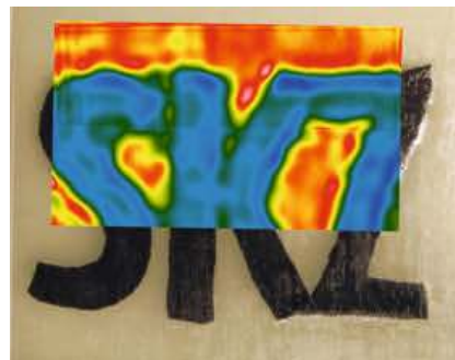
Bild 5. Überlagerung des Fotos eines Faserverbundprobekörpers aus Epoxidharz mit Glasfasergewebe und innenliegendem SKZ-Logo aus 95 % Baumwolle und 5 % Elasthan mit einem entsprechenden Amplitudenbild einer Luftultraschallaufnahme in Falschfarbendarstellung
