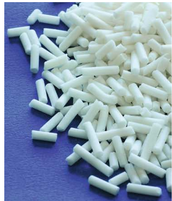
Bild 1. Additivbatches für die UV-Stabilisierung enthalten zu 100 % UV-aktive Systeme aus einer synergetischen Mischung verschiedener Additive
