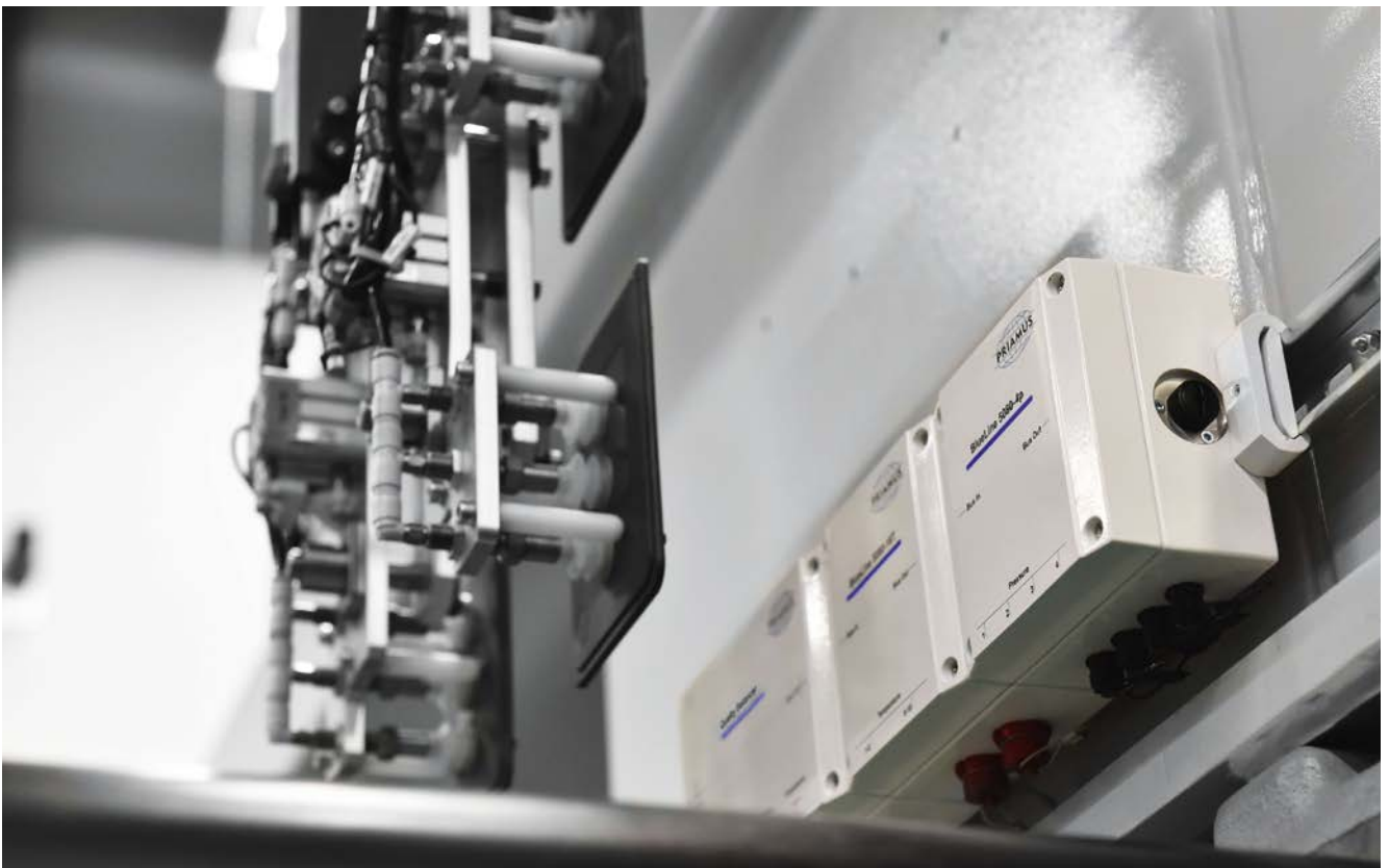
Das „Quality Balancer“-System bei der Produktion eines Deckels für ein ESP-Gehäuse © Priamus
