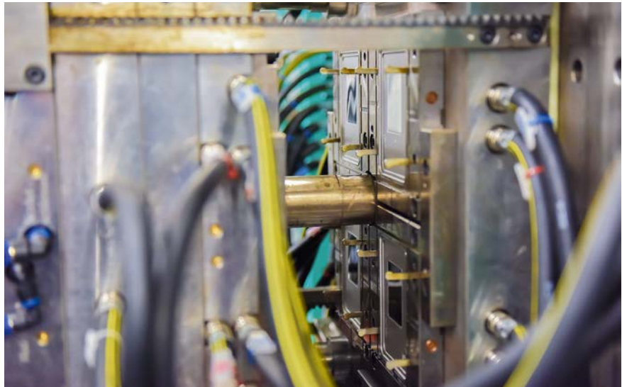
Bild 2. Einblick in das Etagenwerkzeug. Gut zu erkennen sind die Zahnstange und das Schmelzleitrohr (© Priamus)
