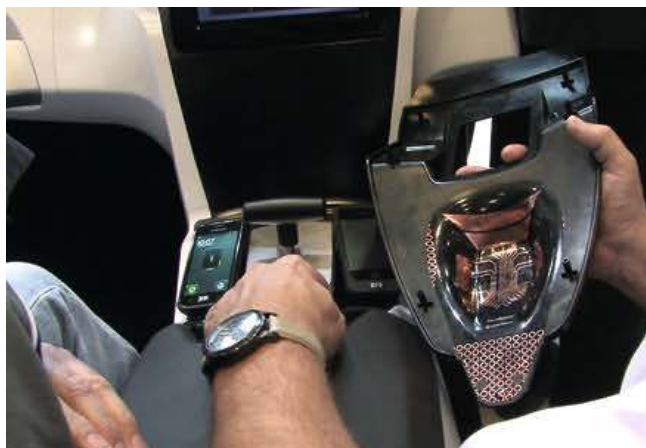
Dreidimensionale Spritzgussteile mit einer äußeren Haut versehen, in der Funktionen integriert sind – z.B. in der Mittelkonsole, auf der sich über Geometrie und Griffgefühl auch im Dunkeln der richtige Punkt intuitiv ertasten lässt, um Bordgeräte zu bedienen (Bilder: Engel)
