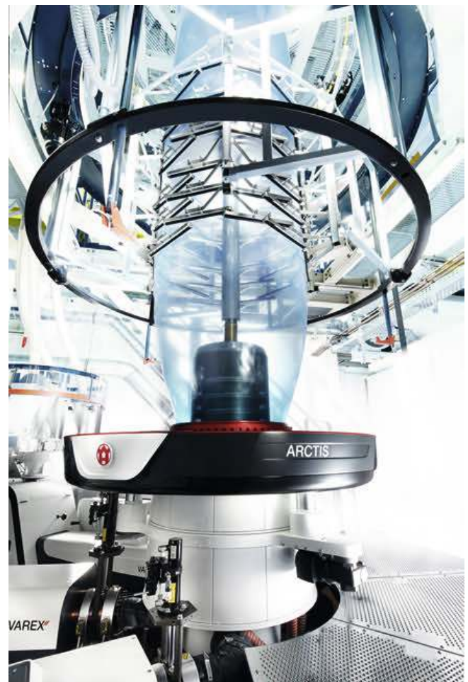
Bild 1. Der Kühlring der Blasfolienanlage Vorex II besteht aus GFK
