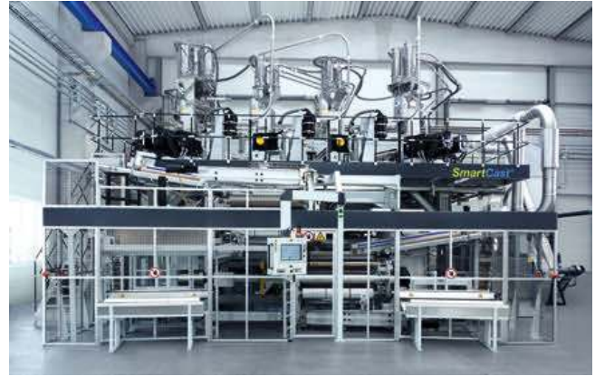
Bild 9. Die Smart Cast Anlage für Stretchfolien erreicht bei einer Foliendicke von 12 µm einen Massedurchsatz von bis zu 1,5 t/h (Bild: SML)
