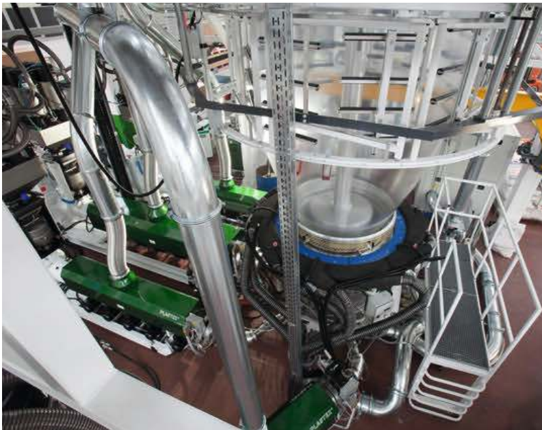
Bild 5. Der Kühlring CR-K3 aus kohlefaserverstärktem Kunststoff verbessert die Luftführung und erhöht die Ausstoßleistung (Bild: Macchi)
