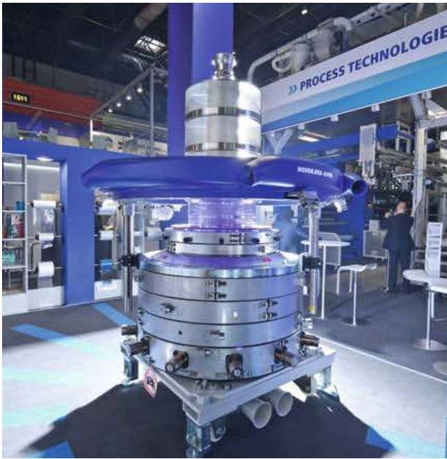
Bild 2. 11-Schicht Blaskopf der X-Baureihe (Bild: Hosokawa Alpine)
