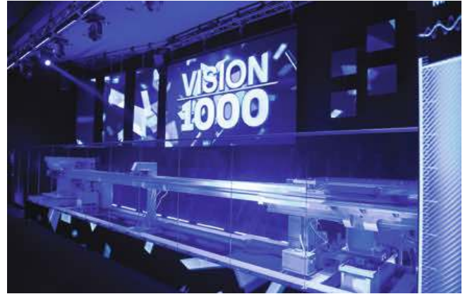
Bild 12. Die Kettenschiene mit einer Geschwindigkeit von 1088 m/min illustriert die Zielsetzung einer Produktionsgeschwindigkeit von 1000 m/min (Bild: Brückner)
