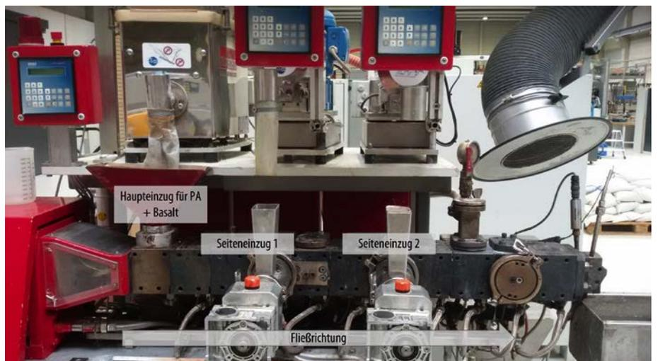
**Bild 2.** Übersicht der Zugabeorte bei der Compoundierung im Zweischnckencomponuder
