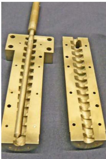
**Bild 2. Bei der Inversschnecke sind die Schneckengänge auf der Innenseite des Zylinders angebracht. Im Inneren rotiert ein Kolben, der in seinem Durchmesser auf die geringen Schussgewichte von Mikroformteilen angepasst ist**
