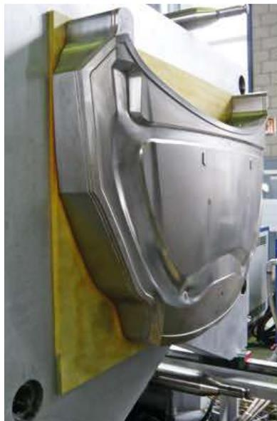
**Bild 3. Die Formenträger der Spaltprägnieranlage können mit einer Schließkraft von bis zu 90 t verriegeln, so wird im Werkzeug für die CFK-Motorhaube ein flächiger Druck von 7,5 bar erzeugt**
