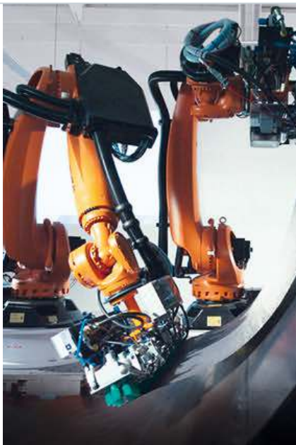
Das koordinierte Legen von Fasermatten ist ein Beispiel für effiziente Automatisierung
