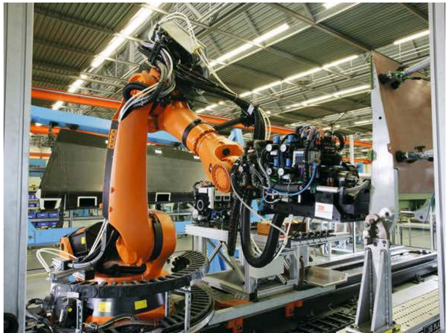
Bohren und Fräsen sind Aufgabenbereiche, die der Industrieroboter in der Leichtbaubranche problemlos übernehmen kann (Bild: Kuka Roboter)
