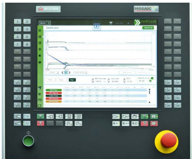
Bild 1. Spritzgießen ohne Druckspitzen: Die iMFlux-Steuerung sorgt dafür, dass die Kavitäten mit einem niedrigen, konstanten Schmelzdruckprofil gefüllt werden (© Milacron)
