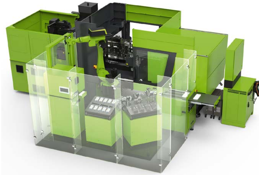
Bild 3. Für die vollautomatisierte Variantenfertigung integriert die Systemlösung sternförmig um den Knickarmroboter die Spritzgießmaschine, einen Bahnhof für die Greifer und Werkzeugeinsätze, einen Laserprinter, eine Montagevorrichtung und eine Schleuse für die Fertigteile (© Engel)
