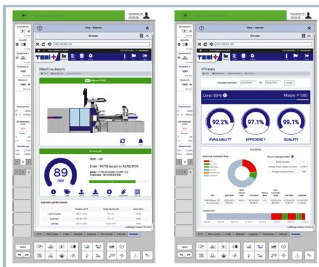
Bild 2. Einfach und übersichtlich stellt Temi+ wesentliche Produktionskennzahlen der Arbeitszelle grafisch dar. Auf Basis von „Wittmann 4.0“ können erstmals auch die Kennzahlen von Peripheriegeräten ausgewertet werden (© Wittmann Battenfeld)
