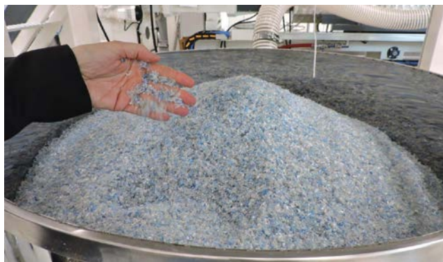
Bild 2. Bottle-Flakes: Je nachdem, wie hoch die Anforderungen an das Endprodukt sind, lassen sich unterschiedliche Qualitäten des PET-Recyclingmaterials separat oder in Kombination nutzen
