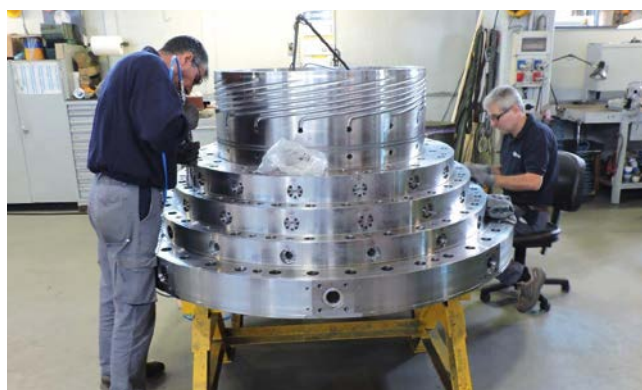
Bild 3. Schlüsselkomponenten: Die für die Qualität des Extrusionsprozesses entscheidenden Werkzeuge fertigt Bandera im eigenen Unternehmen
