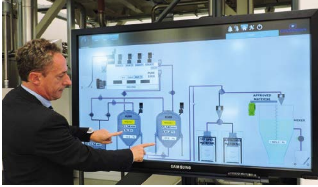
Bild 1. Materialfluss: Andrea Carraro erläutert die Aufbe- reitung der Bottle- Flakes zu lebensmit- teltauglichem PET in der Anlage zur „Purifizierung“
