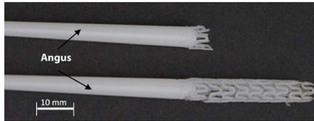
**Bild 6.** Vergleich der Formfüllung ohne (oben  $T_{Wz} \approx 90^\circ\text{C}$ ) und mit (unten  $T_{Wz} \approx 230^\circ\text{C}$ ) variothermer Werkzeugbeheizung
