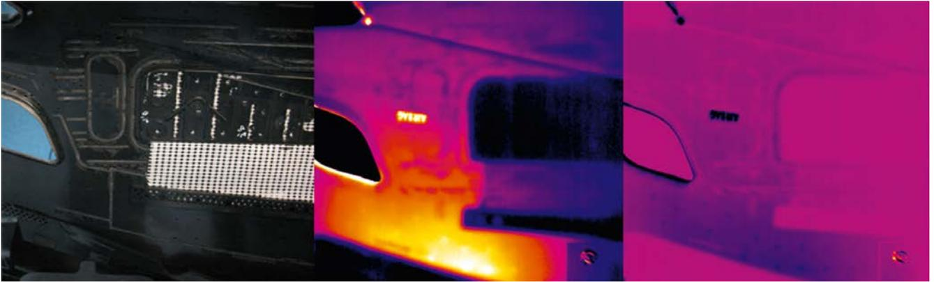
**Bild 4.** Für dünnwandige und großflächige Kunststoffbauteile gut geeignet: optische Lock-in-Thermografie der Rückseite eines Armaturenbretts mit aufgeschweißten Strukturen (links) sowie Amplituden- (Mitte) und Phasenbild (rechts) des Armaturenbretts (© SKZ)
