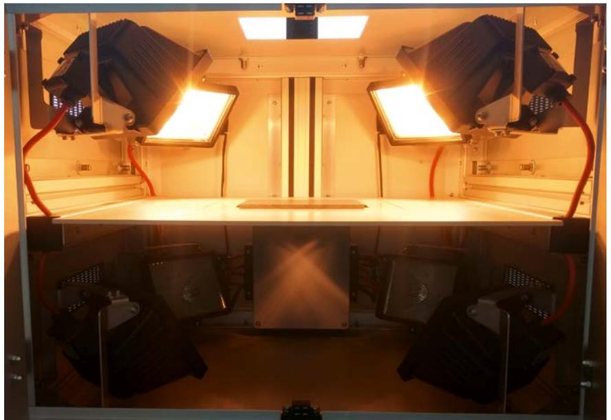
Aktive Thermografie im Einsatz: Bei diesem Aufbau für die optische Anregung mit Halogenstrahlern ist die Thermografiekamera von oben durch die Öffnung auf die Bauteile gerichtet (© SKZ)
