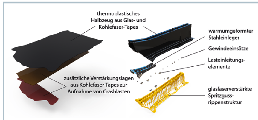
Bild 1. Aufteilung des Laminataufbaus (links) und prinzipieller Aufbau des hybriden Mittel-tunnels (rechts) nach [5] und [6]
