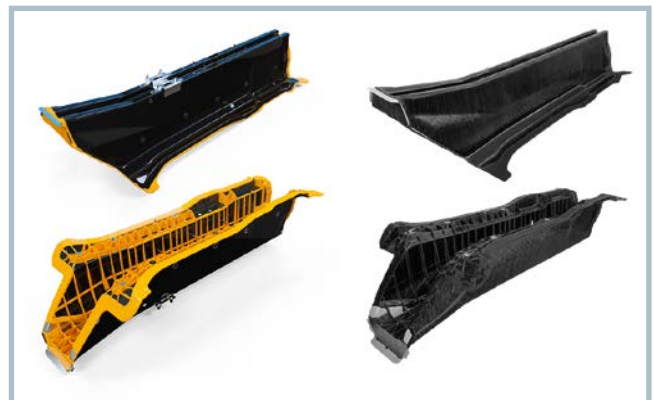
Bild 3. Mittelunnel in Hybridbauweise in CAD-Darstellung (links) und als Realbauteil (rechts) (© Porsche, VW, IK)
