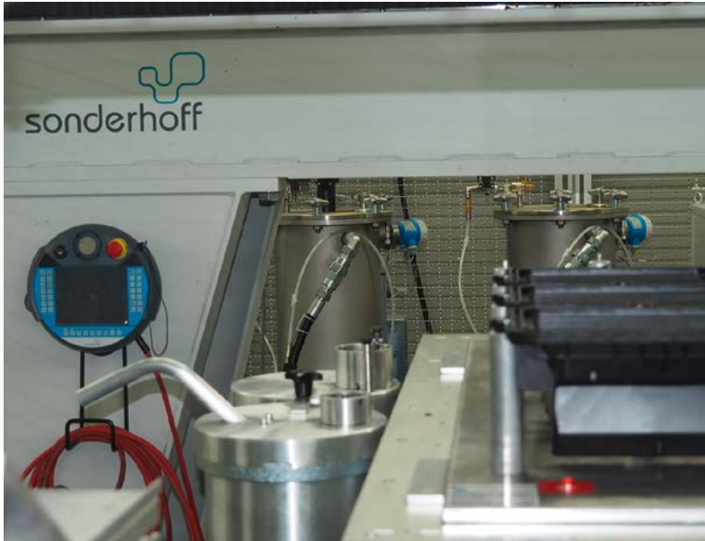
Blick in das Innere der Mitteldruck-Misch- und Dosieranlage DM 402 CC: im Hintergrund die Vorratsdruckbehälter für die A- und B-Materialkomponenten (© Hanser/C. Doriát)
