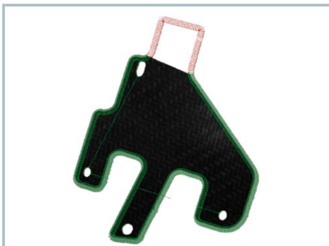
Bild 2. Die beispielhafte Konturmessung eines Organoblechs mittels Kamerasystem deckt mögliche Fehlstellen (im Bild rot) auf (© KraussMaffei)
