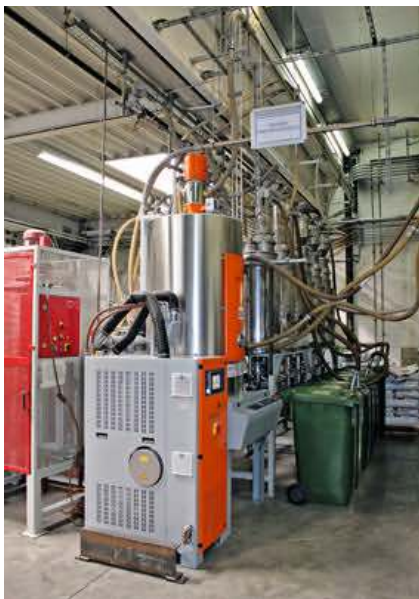
Bild 4. Ausgerüstet mit einer automatischen Temperatur- und Taupunkt-Nivellierung (ATTN) regelt der Trockenluftheizer Luxor A 120 den Taupunkt der Prozessvorluft mit einer Genauigkeit von \pm 1^\circ\text{C}
