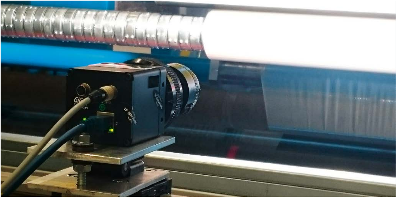
Folie fest im Blick: Da der Arbeitsabstand der Kamera zur Folie fix ist, variiert je nach Rollenbreite und Zuwachs des Rollendurchmessers während der Produktion die Größe des vom Bildverarbeitungssystem auszuwertenden Bereichs (© Strelen)
