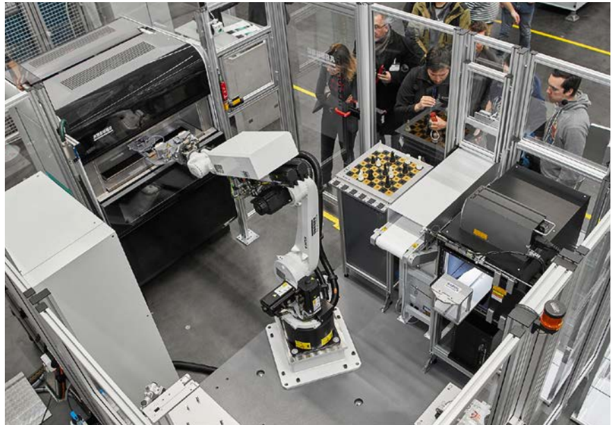
Die zentralen Elemente der „AM Factory“ sind ein Freeformer 300-3X, ein Sechssachsroboter von Kuka und das Scada-System „Arburg Turnkey Control Module“ (© Arburg)
