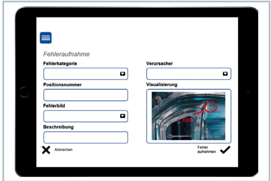
**Bild 3.** Die IDA-App ermöglicht die Erfassung und Dokumentation von Fehlern am Ort ihres Auftretens (© WBA Aachener Werkzeugbau Akademie)
