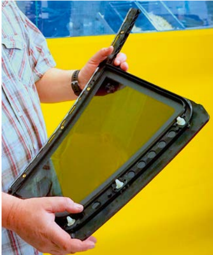
Bild 1. Das Seitenfenstermodul ist eine Baugruppe aus Glasscheibe und vorgefertigten Einlegeteilen, die mit einem Rahmen aus TPE zusammengefasst werden (© Technokomm/R. Bauer)
