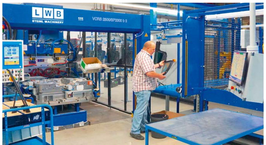
Bild 4. Die LWB-Anlage ist Teil einer Produktionszelle, in der die Glasscheiben vor den Umpritzen an den Kontaktflächen zum TPE mit einem Primer beschichtet werden (© Technokomm/R. Bauer)
