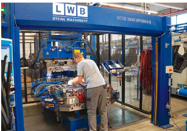
Bild 2. Der großzügig bemessene Freiraum rund um den Drehtisch schafft ergonomisch günstige Voraussetzungen für die Teilemanipulation und die Werkzeugwartung (© Technokomm/R. Bauer)
