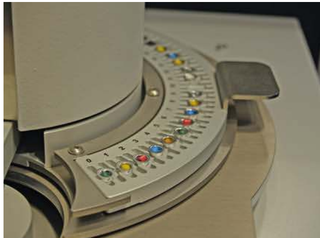
Bild 4. Vorbereitete Proben für eine differenzkalorimetrische Messung. Das Granulat muss vorher manuell zerteilt, in Probentiegel gefüllt und auf der Vorrichtung abgestellt werden. Von da an läuft die Messung vollautomatisiert
