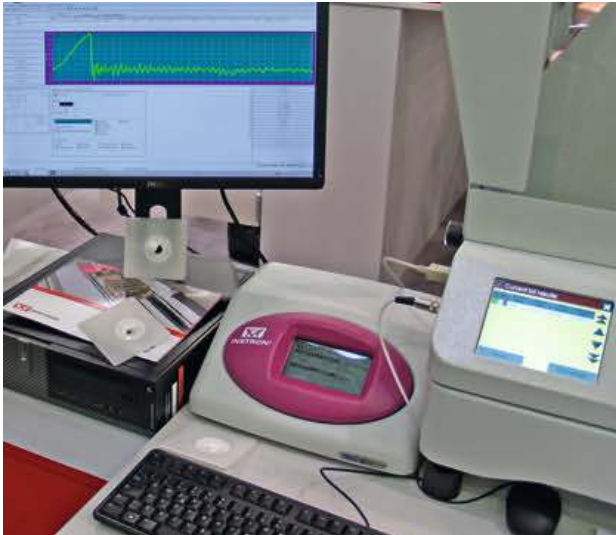
Bild 2. Zwischen Prüfgerät und Computerauswertung ist die Hochgeschwindigkeits-Datenerfassung geschaltet. Besonders bei schnellen Ereignissen wie in Pendelschlag- und Fallwerken ist hier eine hohe Messrate gefordert
