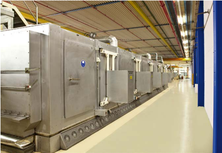
Bild 3. Produktionsanlage für Separatorfolien
