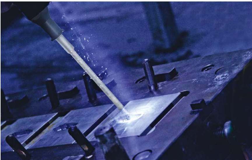
Die Kombination aus kinetischer Energie und thermischem Schock führt bei der Trockeneisreinigung dazu, dass sich Verunreinigungen von der Werkzeugoberfläche lösen (Bilder: Cold Jet & MPC)
