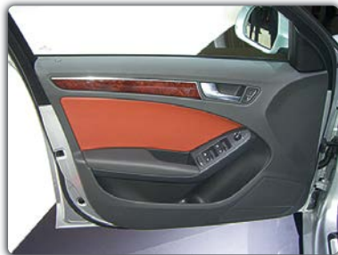
Türverkleidung im Audi A4 (B8) als Spritzgussbauteil
