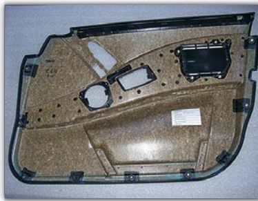
Türverkleidung im 5er BMW (E60) als naturfaserverstärktes Pressbauteil
