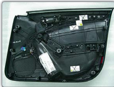
Türverkleidung im 5er BMW (E60) als naturfaserverstärktes Pressbauteil
