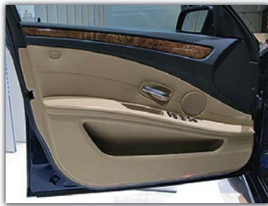
Türverkleidung im 5er BMW (E60) als naturfaserverstärktes Pressbauteil
