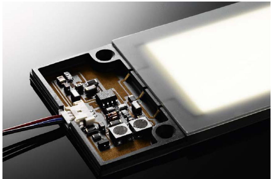
Für das OLED-Lichtelement Orbeos Air (Hersteller: Osram AG, München) kam ein LCP-Typ zum Einsatz, der für die Herstellung von Molded Interconnect Devices (MID) geeignet ist (Bild: Osram Opto Semiconductors)
