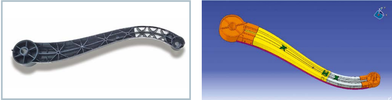
Bild 4. Für die Herstellung des Hebels werden unterschiedlich dicke Organoblechzuschnitte belastungsgerecht im Werkzeug eingelegt
