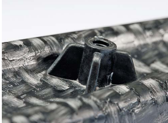
Bild 5. Der Anschraubpunkt wird durch das Gewebe des Organoblechs angespritzt (Bild: Georg Kaufmann/Arburg)
