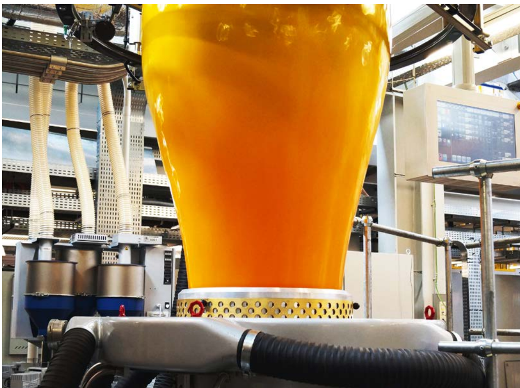
Die Evolution-3-Schicht-Ultra-Fusion-Anlage produziert gelb/schwarze Folie mit hohem Anteil an \text{CaCO}_3 -Pulver für die Verpackung von Blumenerde (Bild: Reifenhäuser)
