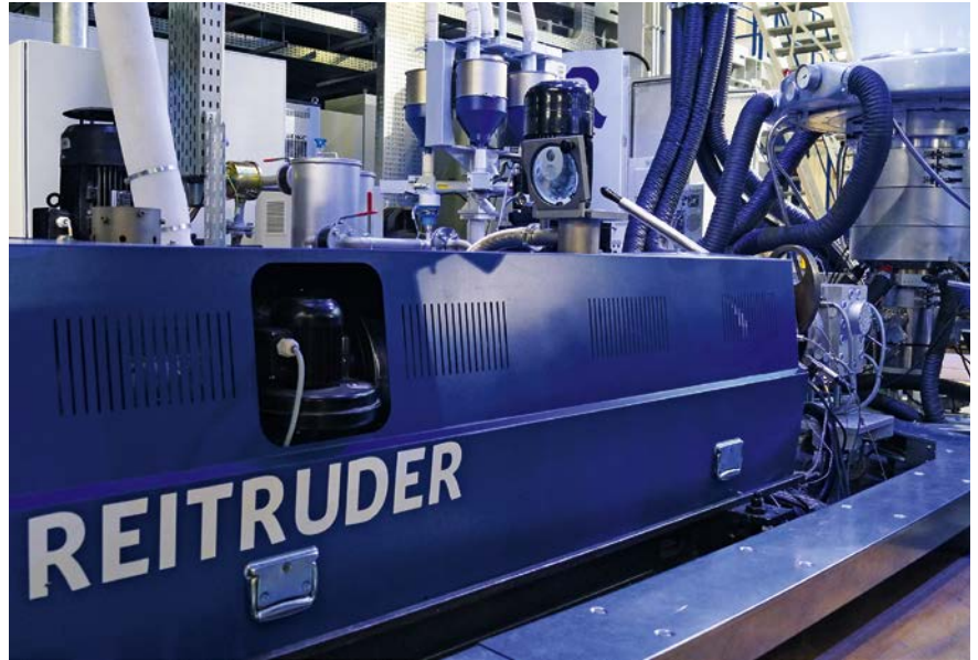
Bild 1. Der REItruder – ein spezieller gleichlaufender Doppelschneckenextruder – ist in einer Evolution-3-Schicht-Blasfolienanlage eingebaut (Bild: Reifenhäuser)
