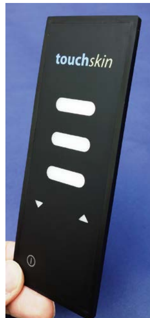
Bild 6. Evolutionsstufe 3 ist die Abkehr vom vollflächigen Hinterspritzen der eigenstabilen Folien-Verbundstrukturen. Die Alternative ist das Umspritzen mit einer Rahmenstruktur, die gleichzeitig Träger der mechanischen Schnittstellen zu den Partnerteilen ist, hier am Beispiel einer 2,2 mm dicken multiskin-Verbundplatte mit integriertem Beleuchtungssystem und 12-Pin-Elektro-Steckverbindung (Bilder: R. Bauer)
