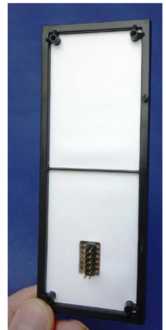
Bild 6. Evolutionsstufe 3 ist die Abkehr vom vollflächigen Hinterspritzen der eigenstabilen Folien-Verbundstrukturen. Die Alternative ist das Umspritzen mit einer Rahmenstruktur, die gleichzeitig Träger der mechanischen Schnittstellen zu den Partnerteilen ist, hier am Beispiel einer 2,2 mm dicken multiskin-Verbundplatte mit integriertem Beleuchtungssystem und 12-Pin-Elektro-Steckverbindung (Bilder: R. Bauer)
