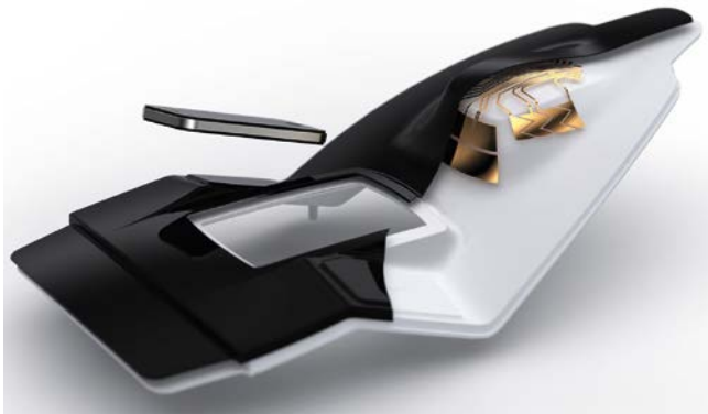
Bild 2. Die nächste Evolutionsstufe 2011, demonstriert am Beispiel einer Pkw-Mittelkonsole mit einem Sensorbereich zur zentralen Infotainment-Bedienung, lässt eine stärkere dreidimensionale Verformung der nach wie vor hinterspritzten Funktionsfolien erkennen (Bild: plastic electronic)
