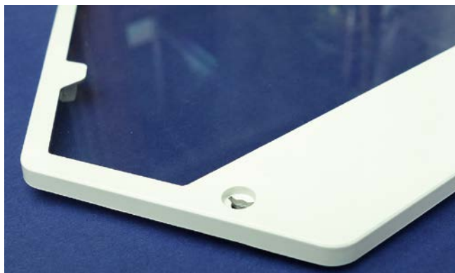
Bild 7. Das Montagespritzgießen ermöglicht stufenlose Übergänge von Folienoberflächen zu den Kunststoffstrukturen selbst bei variabler Insertdicke. Oben die Kombination aus mattschwarzer Dekorfolie und spritzgegossener Hochglanzoberfläche, unten die flächenbündige, spaltfreie Einbettung einer mit Hard-Coat beschichteten Klarsicht-Scheibe aus PC (Bilder: R. Bauer)
