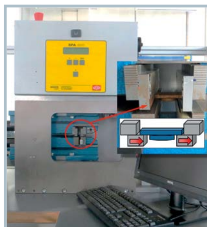
Bild 6. LSV-Prüfapparatur, Einspannung des Probekörpers sowie Bewegungsführung während der LSV-Prüfung (Bild: SKZ)
