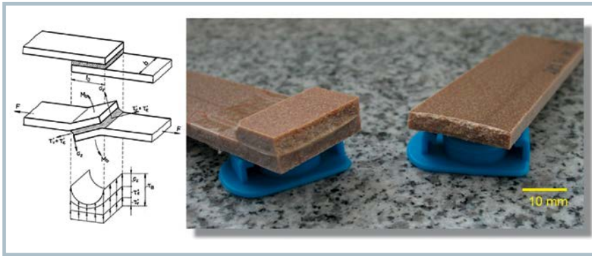
Bild 2. Mehraxialer Zustand einer einfach überlappten Zugscher-Probe mit Spannungs- und Biegemomentverteilung vor und während der Prüfung nach [2] (links), Bruch im Grundmaterial einer Kunststoffprobe (rechts) (Bild: SKZ)
