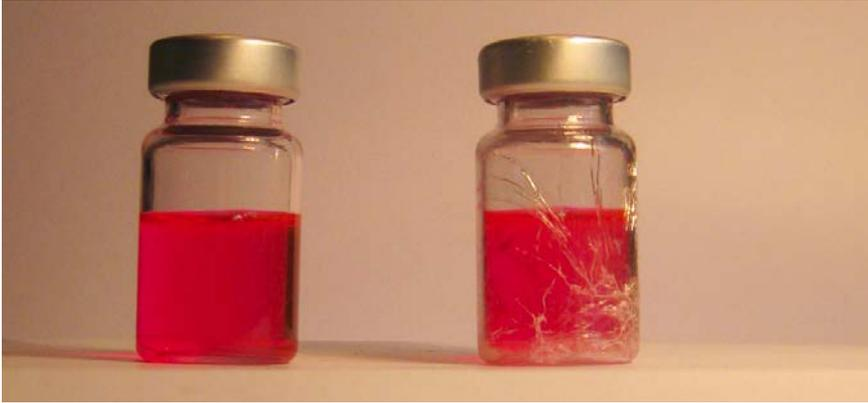
**Bild 5.** Die mehrschichtigen COP-Fläschchen werden befüllt, verschlossen und einem Schlagtest unterzogen. Der Test wird im Einklang mit den Kriterien der Fehlerbewertungsliste für blasgeformte Kunststoffbehältnisse durchgeführt. Das rechte Fläschchen wird dabei mit einem speziellen Werkzeug malträtiert, mit der Absicht es zu zerstören. Im Anschluss lässt sich keine Form der Undichtigkeit feststellen
