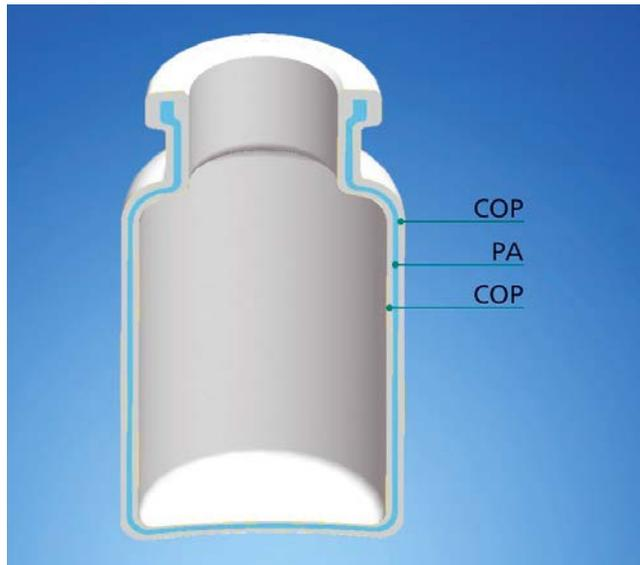
**Bild 4.** So ist ein mehrschichtiges COP-Fläschchen (COP = Zyklisches Olefinpolymer, PA= Polyamid) aufgebaut
