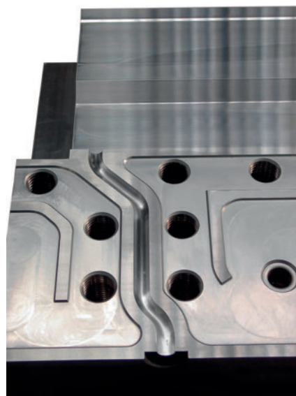
Fig. 2. Edge encapsulation in a slot die (photo: Verbruggen)
